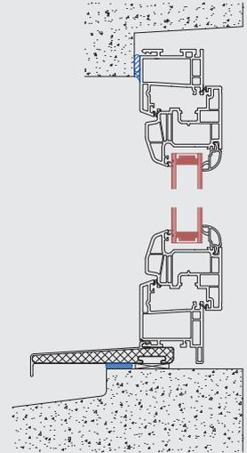
Dormant de 58 mm et pièce d'appui rapportée dépassant de 100 mm
